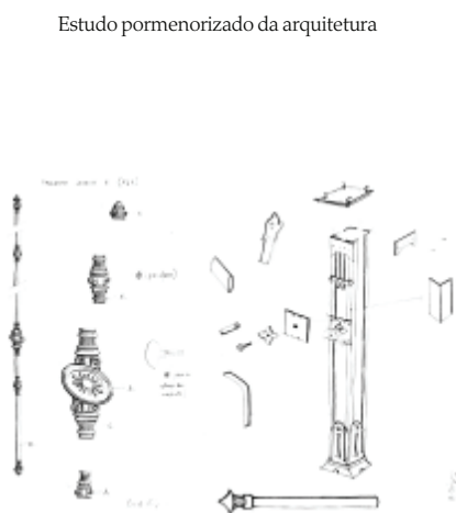
Figura 17: Registro do sistema de encaixe de cremosas e peça ornamental de metal do primeiro período ornamental da casa. Desenho Canteiro- Escola, 1991. Arquivo CPC-USP.
