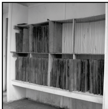
Foto 7: A secagem natural das telhas pré-tratadas foi realizada por um período de 24 horas, antes da posição definitiva na cobertura Foto: Osvaldo Gomes da Silva
